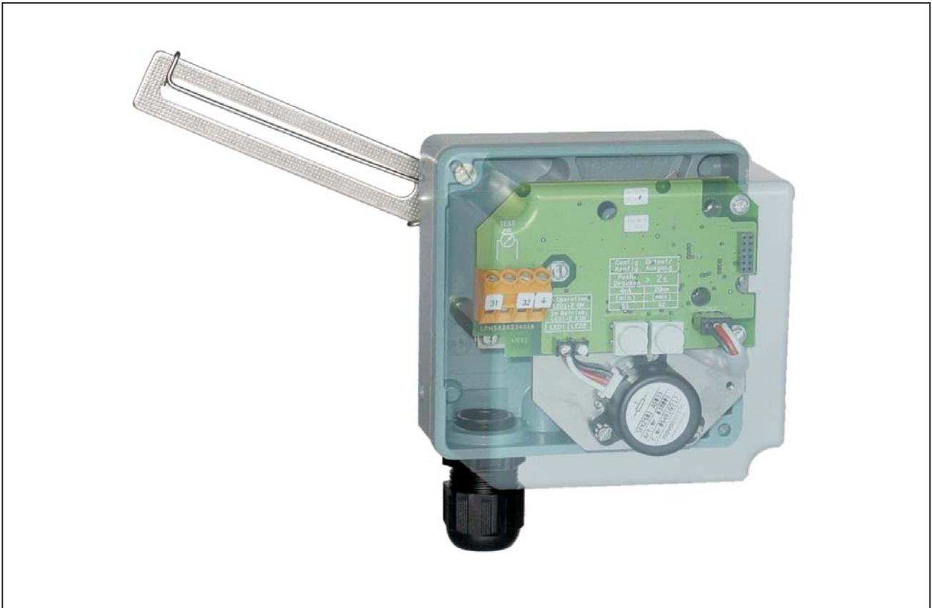
Der elektrische Stellungsumformer SMI983 formt die Hub- bzw. Drehbewegung eines Stellgerätes in ein elektrisches Einheitssignal 4 bis 20 mA um.
