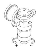
Der reduzierte Druck wird an der Kunststoff-Schraube an der Unterseite eingestellt (Drehrichtung siehe Bild). Die empfohlene Einstellung ist abhängig von der Umgebungstemperatur. Bei der niedrigsten zu erwartenden Temperatur darf es noch nicht zu Kondensation
