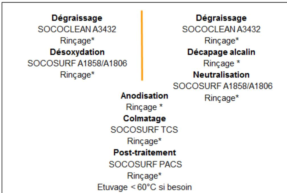
\* Concernant le procédé de rinçage, après chaque étape de traitement les surfaces traitées doivent être rincées idéalement avec de l'eau déminéralisée. Ce procédé doit être adapté à la configuration de la ligne de traitement de surface et sa charge.
