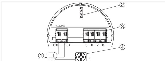
Elektronik- und Anschlussraum Einkammergehäuse
