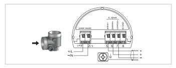
Anschlussraum Zweikammergehäuse - Kleinspannung
