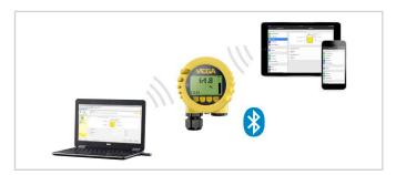
Drahtlose Verbindung zu Standard-Bediengeräten
