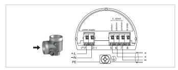
Anschlussraum Zweikammergehäuse - Netzspannung
