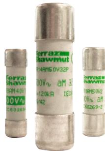
Mersen „aM“ und „gG“ Sicherungseinsätze decken eine große Bandbreite an verschiedenen Größen und Stromstärken für 400, 500 und 690VAC ab. Sie werden für die Absicherung von elektrischen Verteilungsstromkreisen und industriellen Anlagen eingesetzt. Ein Großteil der Stromstärken ist in den Größen 8x31 und 10x38 optional mit Kennmelder, und in den Größen 14x51 und 22x58 optional mit Schlagbolzen zur Auslösung eines Hilfskontakts erhältlich.
