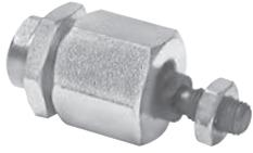
Kupplung zur flexiblen Befestigung der Kolbenstange. Die Flexokupplung ist dazu vorgesehen, axiale Winkelabweichungen im Bereich von  $\pm 4^\circ$  auszugleichen.
