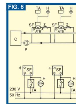
**● ESEMPIO DI APPLICAZIONE PRECEDENZA BOLLITORE** Questo sistema di installazione da noi usato prevalentemente su caldaie combinate permette la regolazione di temperatura del bollitore al valore desiderato. La valvola viene usata come precedenza rispetto all'impianto.
