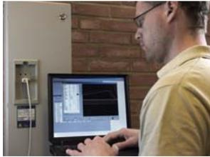
Schließen Sie einen PC mit einem Standard-RS232-Kabel an den D-sub-Stecker an der Oberseite des TSA-Geräts über USB/RS485/Modbus - TCP-Kommunikationsmodule optional. Die PC-Software EmoSoftCom
