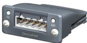
Feldbus-Optionsmodul zur DeviceNet-Kommunikation. Baudraten: 125 – 500 kbit/s unterstützt. Gängige TSA-Ansprechzeit = 10 ms (exklusive eventueller Feldbus-Verzögerungen).
