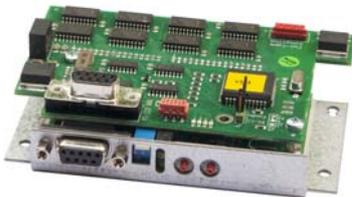
Feldbus-Optionsmodul zur Profibus-DP-Kommunikation.
