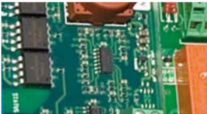
Alle Optionskarten sind auch lackiert erhältlich, empfohlen z. B. für Abfluspumpenanwendungen (Sulfid) oder Installationen mit gelegentlich auftretender hoher Feuchtigkeit (bei einer Montage in Maschinenräumen oder in
