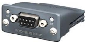
Feldbus-Optionsmodul zur Profibus DP- oder DP V1-Kommunikation. Verwenden Sie einen 9-poligen D-sub-Stecker. Baudraten: 9,6 kbits/s – 12 Mbits/s unterstützt.
