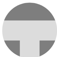
Vanne 3 voies de type T 3 ways T type valve 3 Wege Ventil Typ „T“ Válvulas de 3 vías de tipo T
