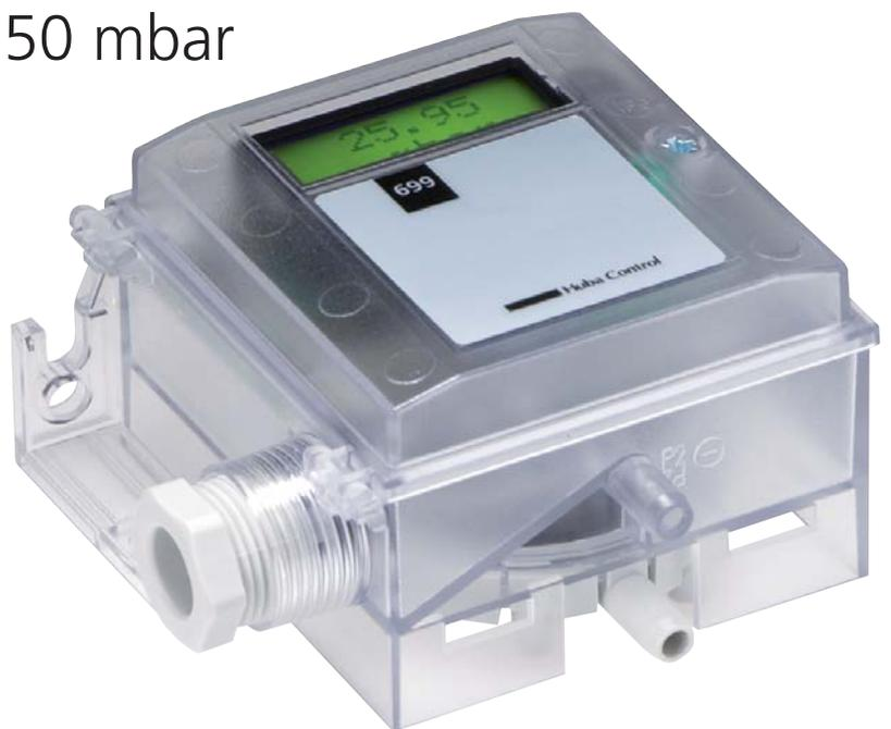
Die Drucktransmitter der Typenreihe 699 sind in den Druckbereichen umschaltbar und mit oder ohne Anzeige lieferbar. Eine Vollversion enthält weitere kundenseitige Einstellmöglichkeiten. Für jeden Druckbereich speziell entwickelte Sensoren erlauben eine physikalisch genaue und langzeitstabile Messung. Die Variantenvielfalt ermöglicht einen vielseitigen Einsatz in der Klimatechnik sowie für feine Messungen im Industrie- und Medizinalbereich.
