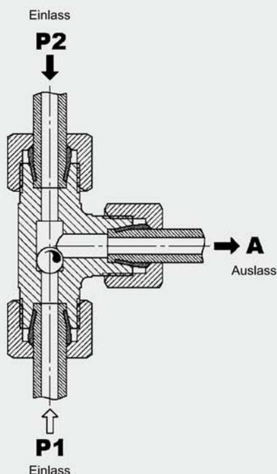
Das Wechselventil WVT ist ein Sperrventil in Kugel-Sitzausführung. Es hat zwei Einlassöffnungen (Anschluss P1 und P2) und eine Auslassöffnung (Anschluss A). Die Einlassöffnung mit dem höheren Druck verschiebt das Schließelement in Richtung der anderen Einlassöffnung. So ist die Einlassöffnung mit dem höheren Druck immer automatisch mit der Auslassöffnung verbunden und die andere verschlossen.
