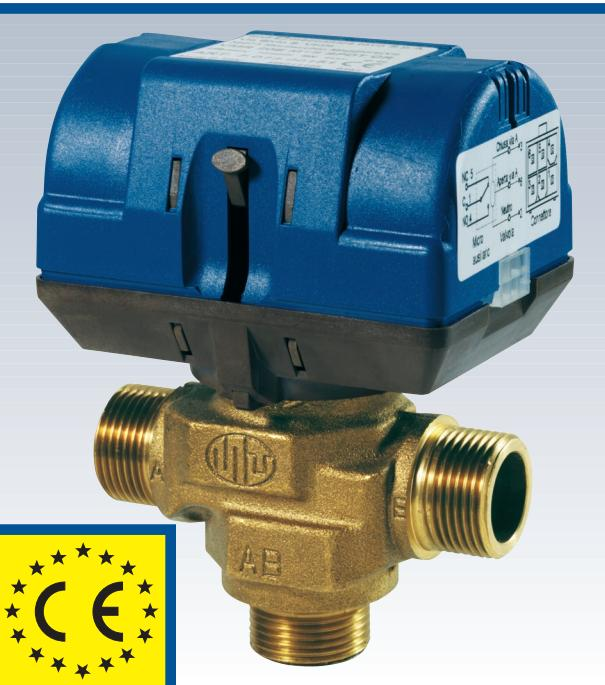
ES. VMR 20 E SPDT CR M15: Valvola VMR a 3 vie, con attacchi filettati maschio G 3/4 secondo UNI ISO 228/1, controllo esterno bipolare, connettore rapido Molex™, micro ausiliario bipolare e motore da 220-240 V a.c.
