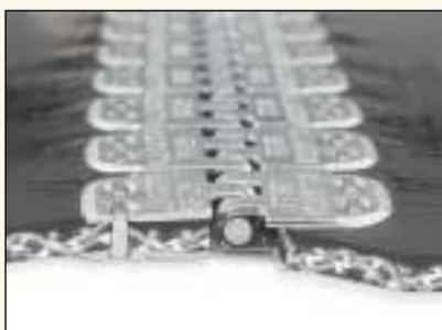
Les crampons penetrent entre les fibres de la carcasse de la bande. Sous l'action du marteau, les crampons traversent la bande puis se rabattent en croix, ce qui les empêche de se defaire sous l'effet de la tension de la bande.
